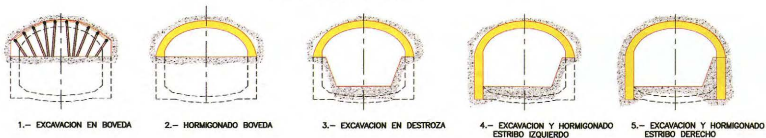
FASES CONSTRUCTIVAS DE TUNEL
